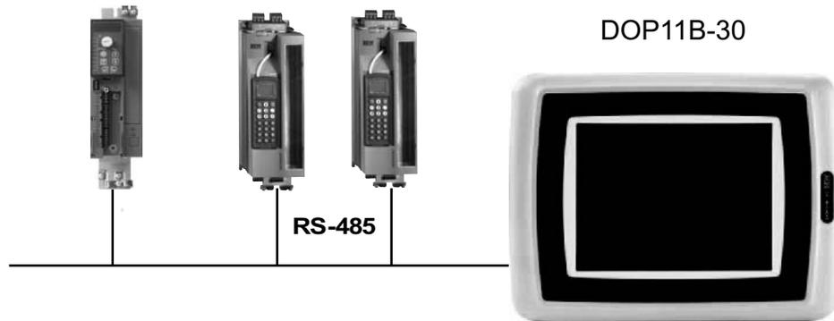
Bild 4: RS-485-Verbindung
