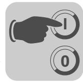
4. Drücken Sie die OK-Taste um die Inbetriebnahme zu starten. Es erscheint der erste Parameter. Das Bediengerät befindet sich im Anzeigemodus, gekennzeichnet durch den blinkenden Cursor unter der Parameternummer.
